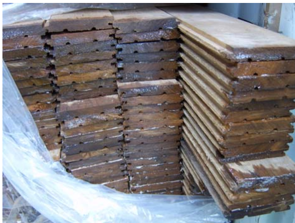
Figura. Duelas de madera en donde se observa penetración de parafina liquida que los extremos de las duelas.
