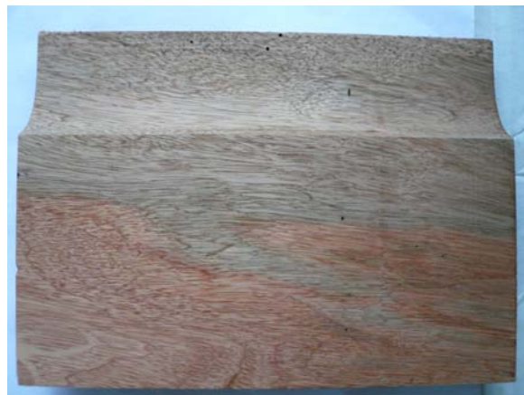
Figura. Duelas de madera en donde se observa penetración de parafina liquida que los extremos de las duelas.
