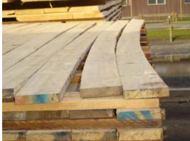
Figura. Madera con tensiones.
