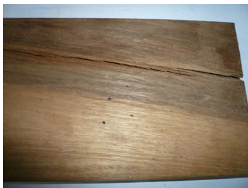
Figura. Madera con polilla, rajaduras y cambio de tonalidad.
