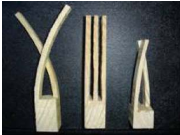
Figura. Probetas mostrando tensión en la madera luego de su secado.
