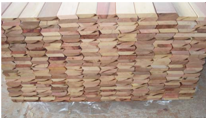
Figura mostrando madera moldurada (zócalos) y cepillada S4S sin grietas en los extremos.
