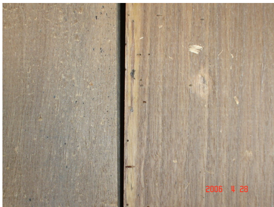
Figura. Duelas de madera en donde se observa penetración de parafina liquida que los extremos de las duelas.
